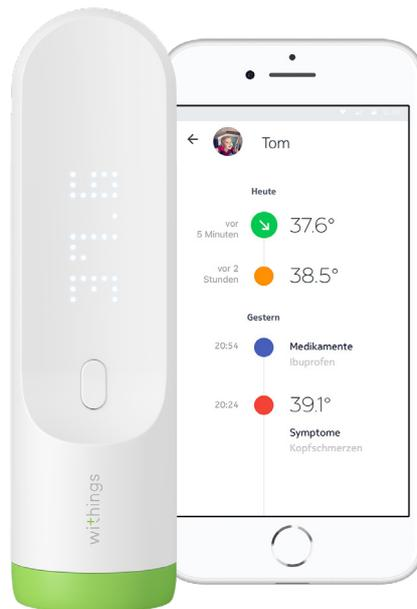
Das WLAN-Schläfenthermometer **Thermo** bietet dank 16 Sensoren die schnellste, genaueste sowie hygienischste Art und Weise, um Fieber zu messen. Die Messungen werden automatisch mit der dazugehörigen App synchronisiert. Damit können Nutzer den Fieberverlauf dokumentieren, Erinnerungen setzen sowie auftretende Symptome und die Einnahme von Medikamenten direkt auf dem Smartphone notieren.
